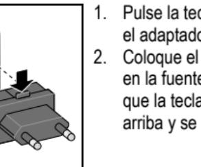
1. Pulse la tecla de desbloqueo 13 mientras extrae el adaptador de enchufe 14 montado.
