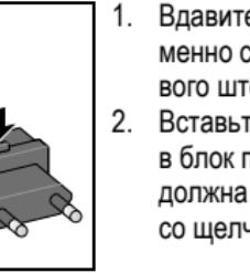
1. Вдавите кнопку разблокировки 13 и одновременно снимите установленный адаптер сетевого штекера 14.
