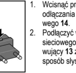
1. Wcisnąć przycisk odblokowujący 13 podczas odłączania zamontowanego zasilacza sieciowego 14.
